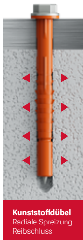
Kunststoffdübel Radiale Spreizung Reibschluss
