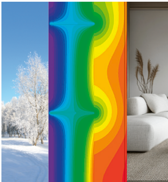
Abbildung 1 Ausgeprägte Wärmebrücke bei Aluminiumkonsolen
